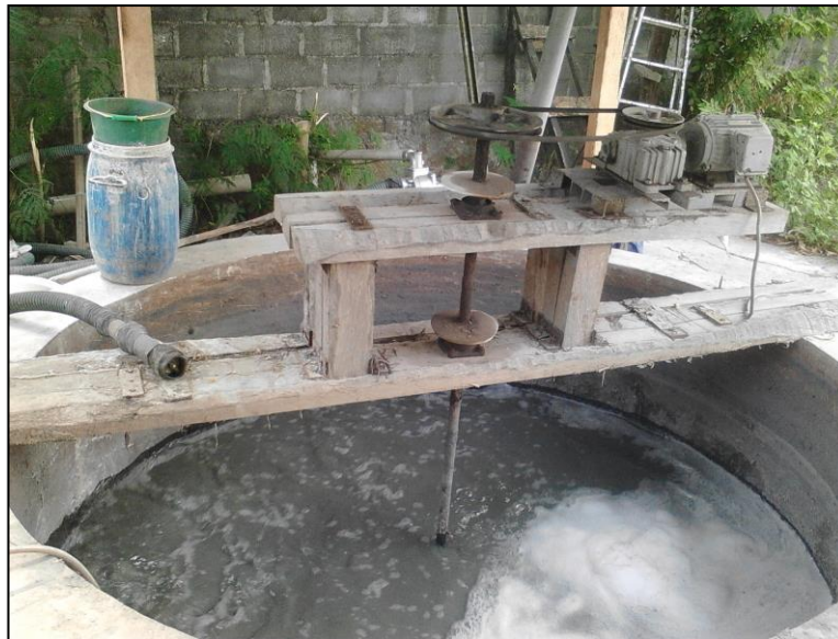
Gambar 3.3 Pengelolaan Limbah cair di industri pengolahan kulit
